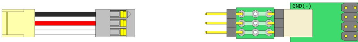
下図のように外すと 12V が来ているピンが露出するため、マザーボードや PC ケースに接触するとショートする恐れがあります。このような状態にしないでください。
