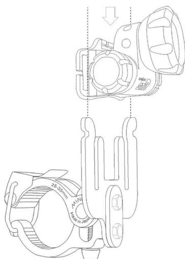
アタッチメントをヘッドライトの電池裏の溝へ
